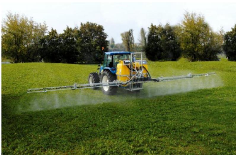
*Figura 26- Barra irroratrice con ugelli antideriva*
