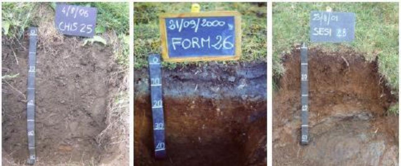
Figura 5-3: Esempi di scavi per rilevazione del profilo pedologico - (fonte "Capacità d'uso dei suoli a scala aziendale Allegato A" IPLA - Regione Piemonte)
