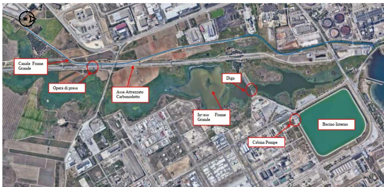
**Figura 2-1: Elementi e manufatti costituenti il sistema di derivazione e stoccaggio delle acque provenienti dal Canale di Fiume Grande.**
