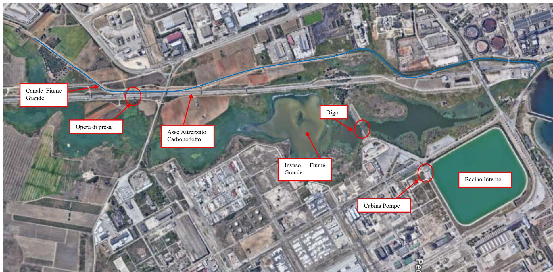
Figura n.1: Sistema di derivazione acque per uso industriale
