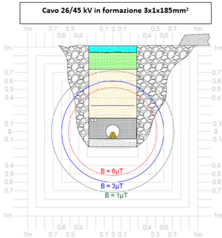
**Fig. 1a** Curve di equilivello per il campo magnetico di una linea interrata in MT con cavo elicordato
