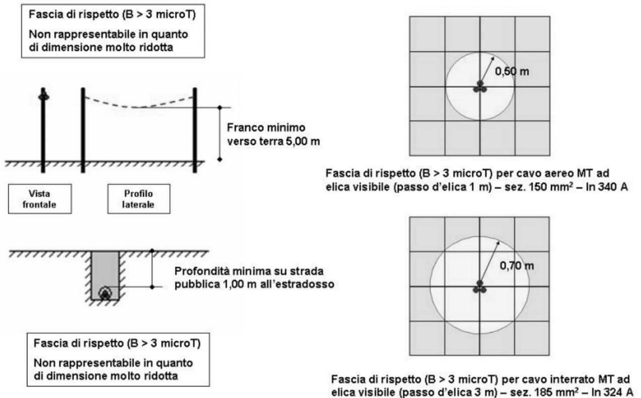
**Fig. 1b** Curve di livello dell'induzione magnetica generata da cavi cordati ad elica – calcoli effettuati con il modello tridimensionale “Elico” della piattaforma “EMF Tools”, che tiene conto del passo d'elica.
