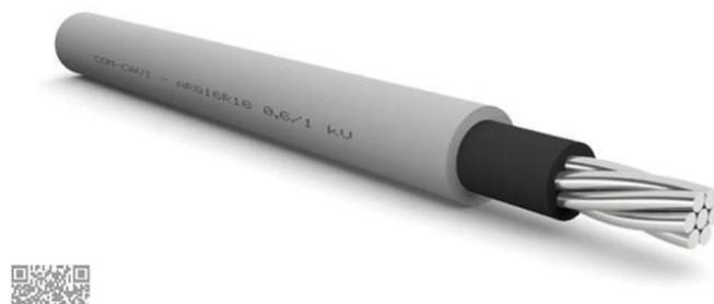
Le linee di Media Tensione, per connessione delle varie cabine di trasformazione dei Sottocampi verso la Cabina di Raccolta, saranno realizzate con l'impiego di cavo precordato ad elica visibile tipo ARE4H5EX 12/20kV XLPE tipo DX3/DX8 con sezione nominale da 35 fino a 95 mm<sup>2</sup>.
