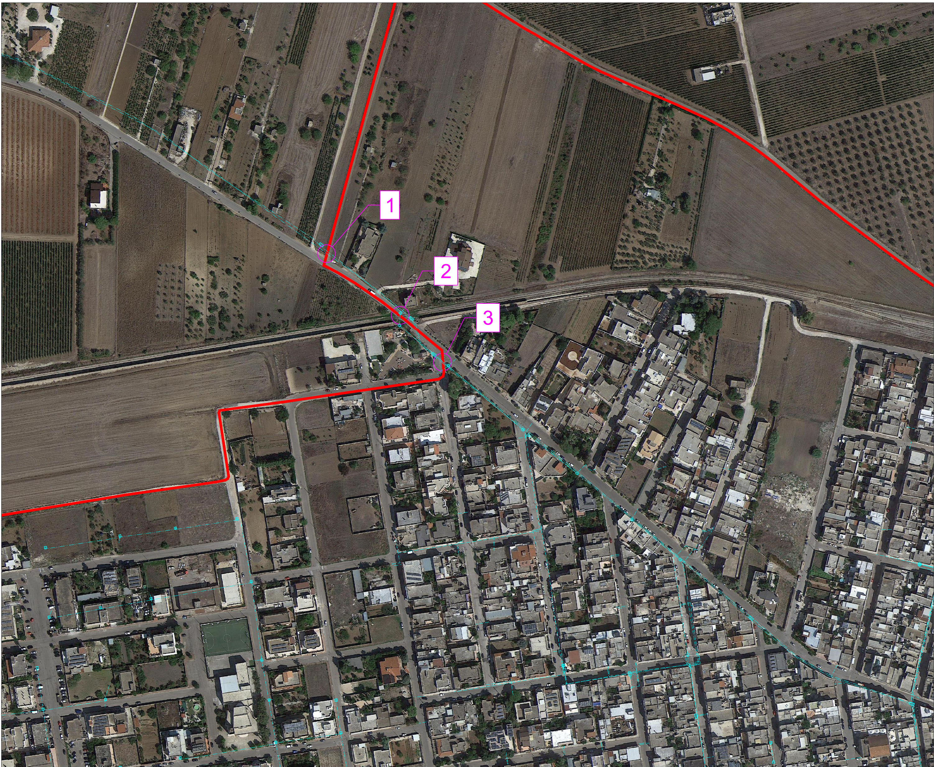
Dettaglio delle interferenze tra il cavidotto di connessione e la rete di telecomunicazione TIM - Scala 1:2.000
