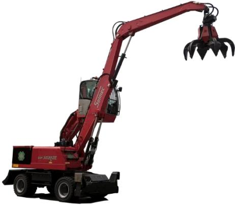
Caricatore semovente con benna a polipo: i caricatori semovente idraulici dotati di polipo presentano una cabina di guida ampia e confortevole, comandi semplici e disposti chiaramente che consentono di ottenerne ottime migliori prestazioni e familiarità col mezzo. Alcuni accorgimenti, inoltre, come i contralberi di bilanciamento montati di serie, aggiungono caratteristiche di comfort superiore alla macchina, diminuendo l'affaticamento dell'operatore. Le capacità di sollevamento dei mezzi sono
