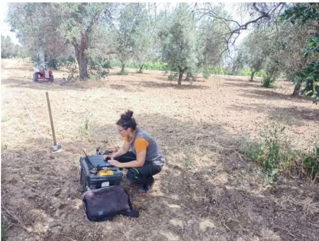
**Figura 6: Stendimento sismico per indagine MASW**
