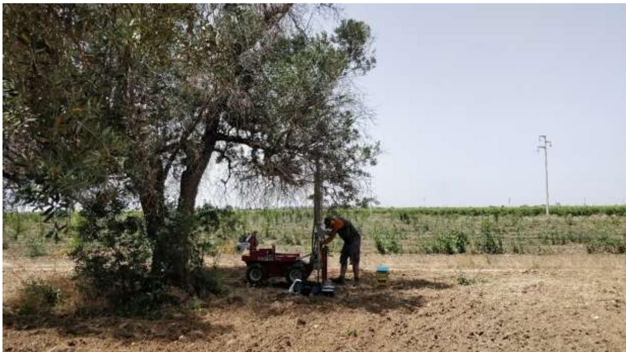
**Figura 5: esecuzione prova penetrometrica P1**
