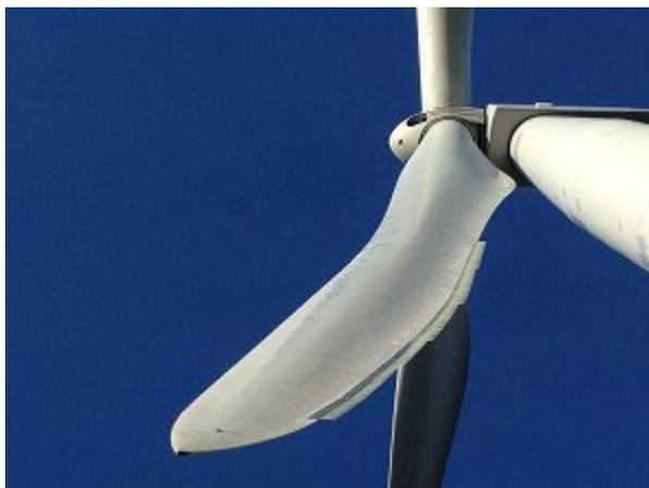
**Figura 7 LNTE sulla pala del rotore della turbina eolica**
