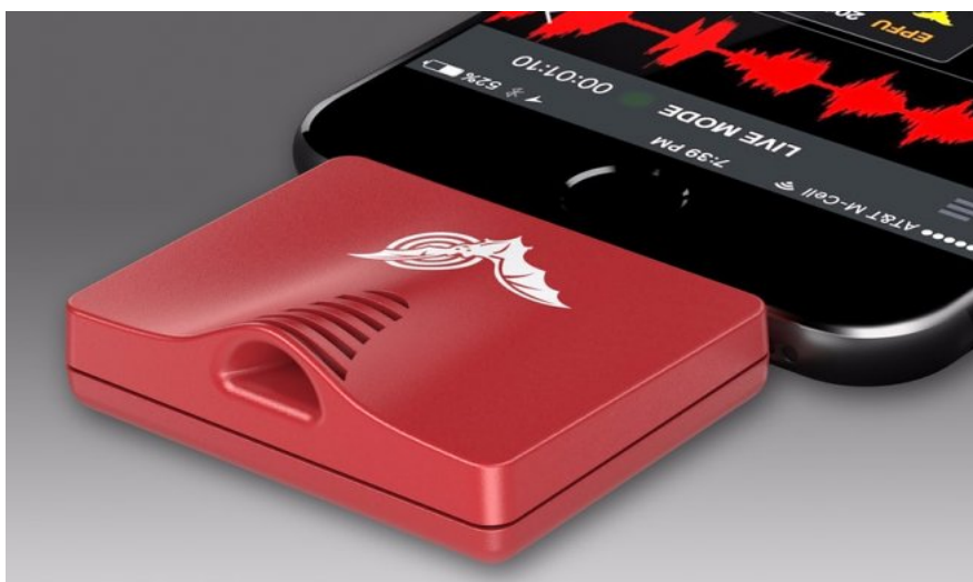
Figura 5.2 – Bat-detector Wildlife Acoustics Echometer Touch 2 connesso a un dispositivo mobile.
