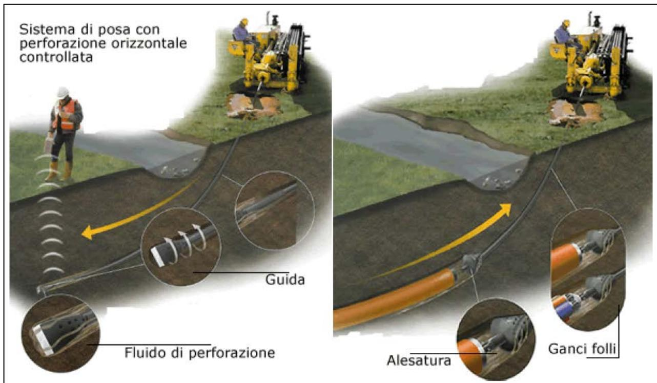
Figura 5 Sistema di posa con tecnica T.O.C. – Trivellazione Orizzontale Controllata
