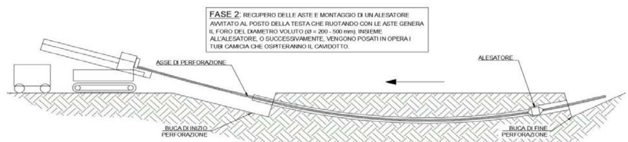
Figura 5 – Schematizzazione della Fase 2 della T.O.C.
