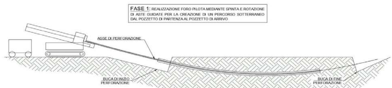
Figura 4 – Schematizzazione della Fase 1 della T.O.C.
