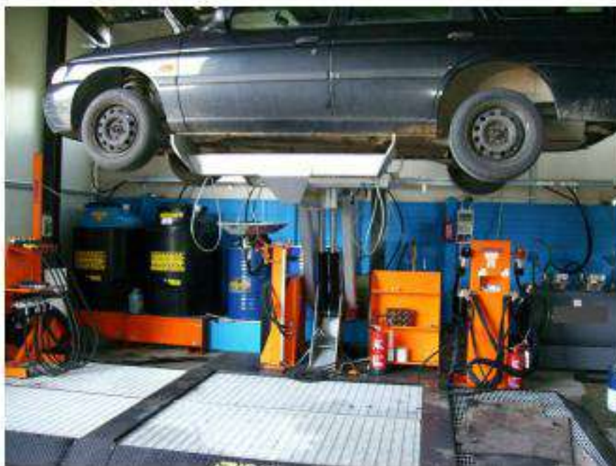
Applicazione di isola di bonifica all'interno di un'autodemolizione
