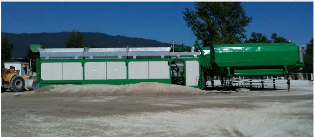
*fig. 04 -Impianto di produzione del conglomerato bituminoso a freddo*
