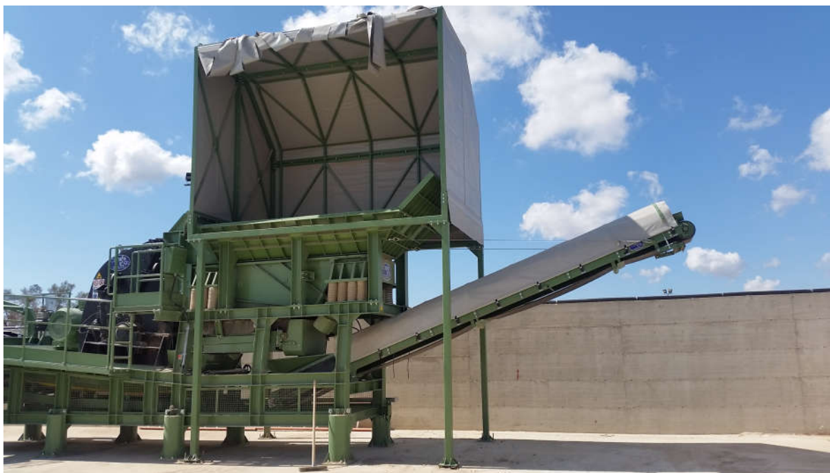
Tramoggia di carico e nastro coperto per lo scarico delle terre
