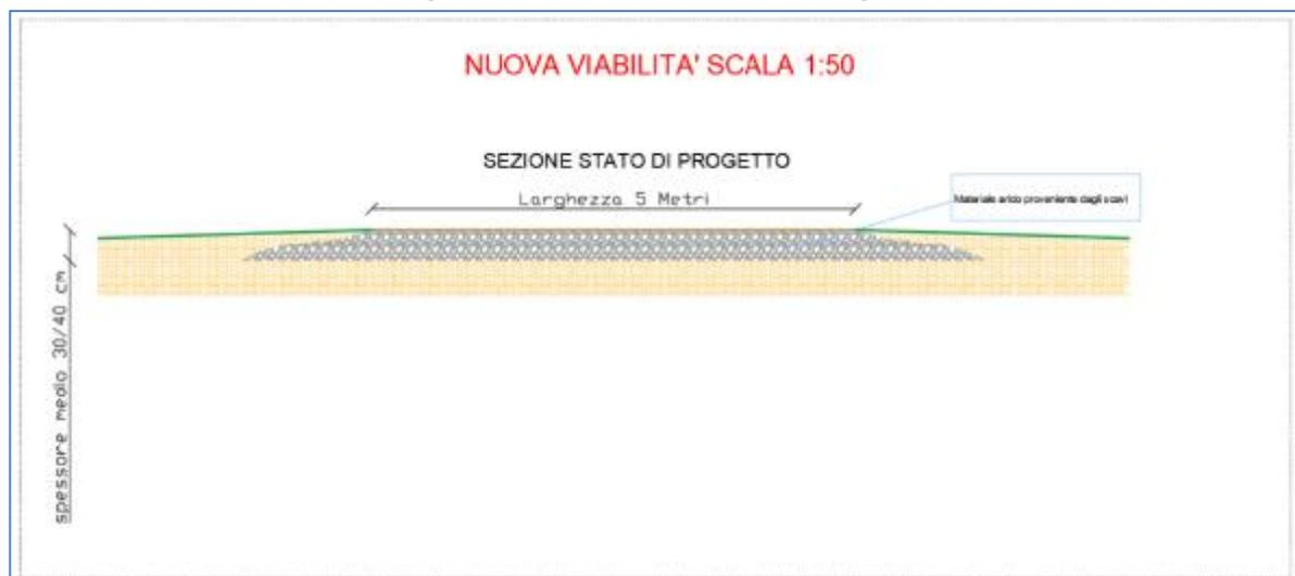
Figura 53 – sezione strade di sicurezza in progetto
