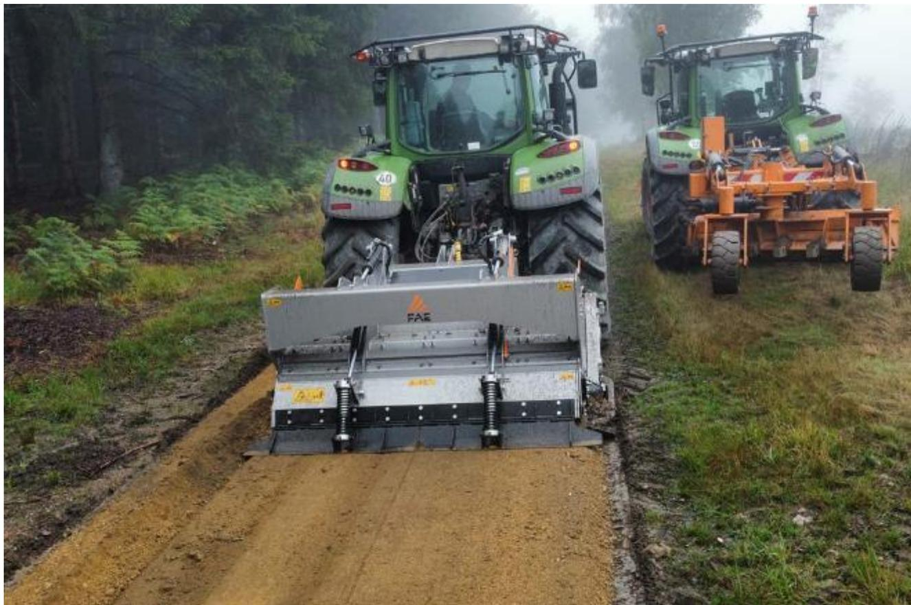
*Figura 122 –trattore fresa stabilizzatrice*
