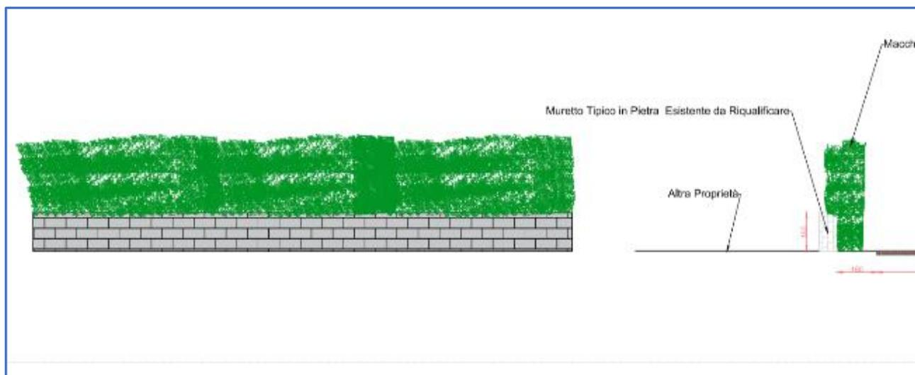
Figura 155 - schemi dell'impianto di mitigazione lungo il perimetro a Nord-Est con ripristino dei muretti a secco esistenti ed infoltimento della macchia mediterranea esistente
