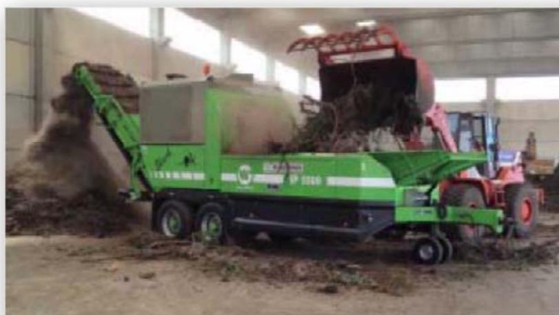
*Figura 3 Triturazione per preparazione miscela*
