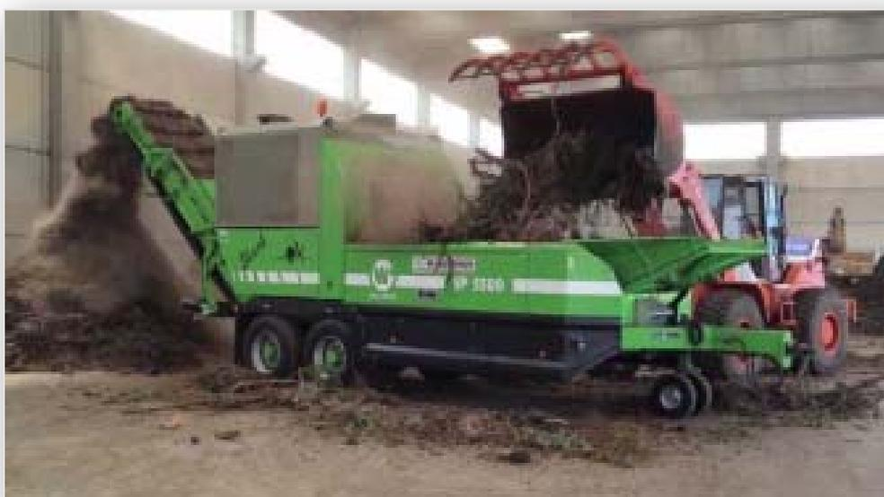
*Figura 3 Triturazione per preparazione miscela*
