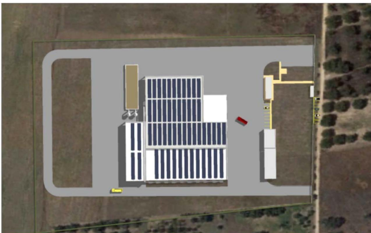
Figura 38 Plano-volumetrico con posizionamento impianto fotovoltaico
