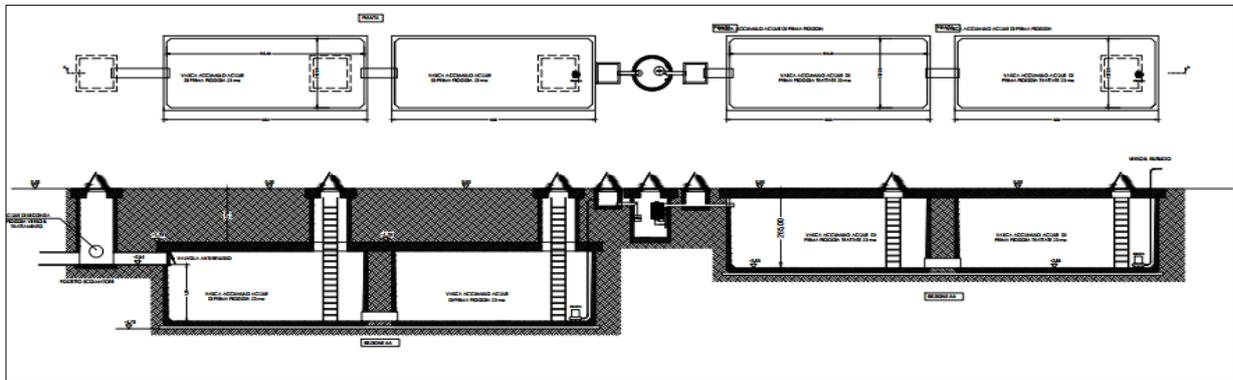
Figura 23 Schema sistema di accumulo e trattamento acque di prima pioggia
