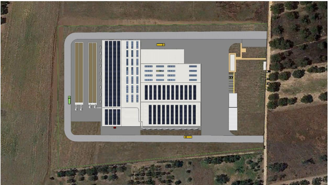
Figura 38 Plano-volumetrico con posizionamento impianto fotovoltaico
