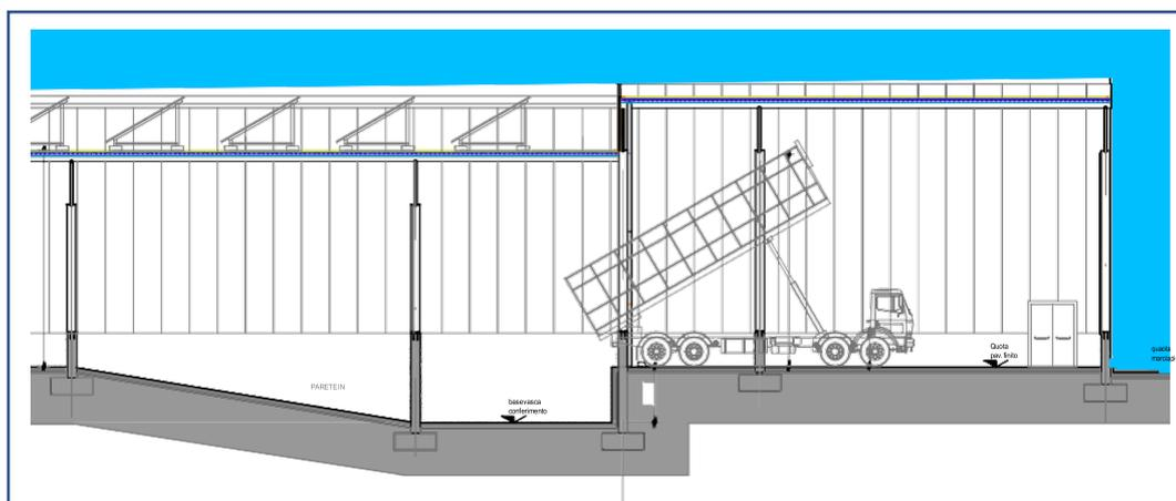
Figura 4 Sezione capannone area conferimento con fossa di scarico
