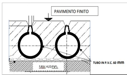
Figura 30 Sezione pavimento biocelle.
