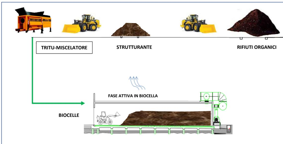
*Figura 4 Processo di Compostaggio In Biocella*
