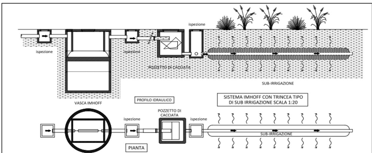
Figura 24 schema impianto trattamento reflui domestici
