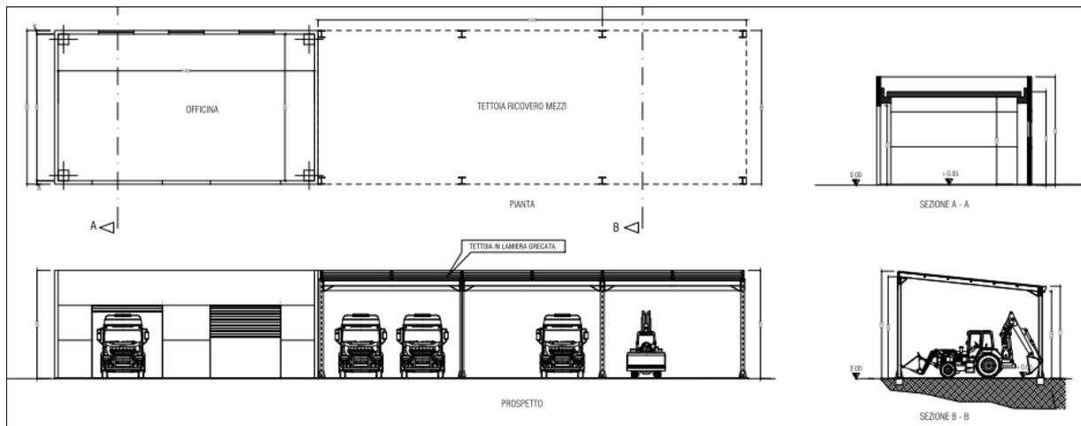
Figura 29 Officina e Tettoia - Parcheggio Mezzi in Manutenzione
