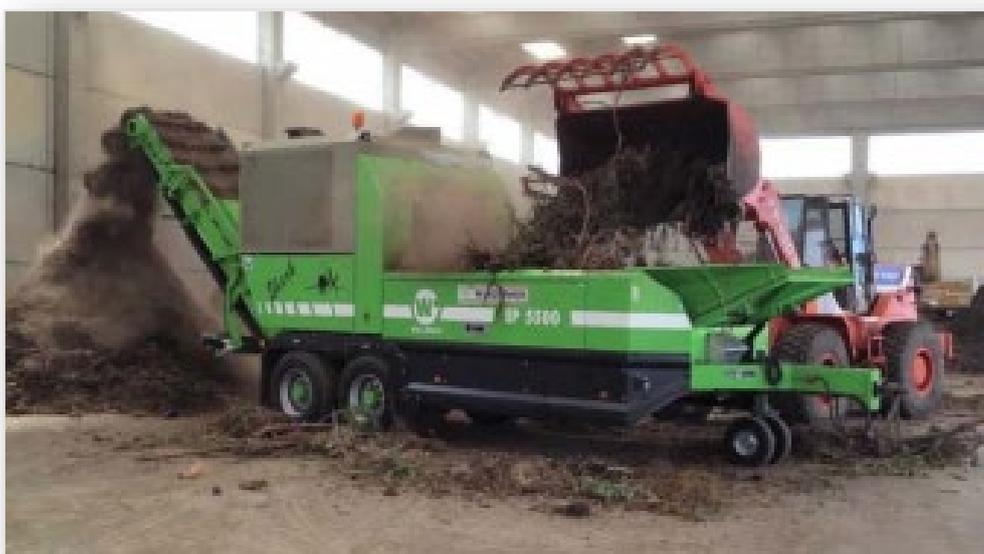
*Figura 3 Triturazione per preparazione miscela*
