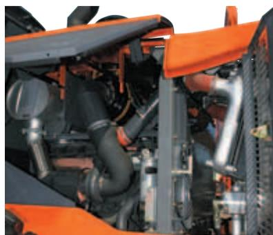
I doppi filtri del combustibile con funzione di sedimentazione, il filtro dell'olio motore e il separatore dell'acqua sono in posizione strategica, per agevolare l'ispezione giornaliera e facilitare la manutenzione al suolo.
