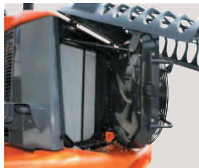
La rotazione della ventola di raffreddamento ad azionamento idraulico con sistema di rilevamento del calore può essere invertita per facilitare la rimozione della sporcizia dal radiatore. Anche la ventola può essere aperta per agevolare la pulizia.
