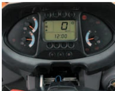
Sul monitor di facile lettura, l'operatore può leggere le istruzioni per le attività programmate di manutenzione e assistenza.
