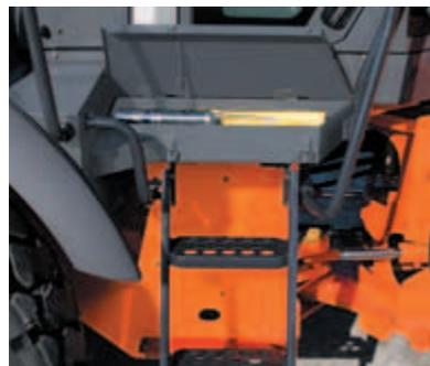
Un'ampia cassetta degli attrezzi trova posto sul gradino superiore sul lato destro della macchina. Nella cassetta è possibile riporre una pistola d'ingrassaggio e un kit di attrezzi.
