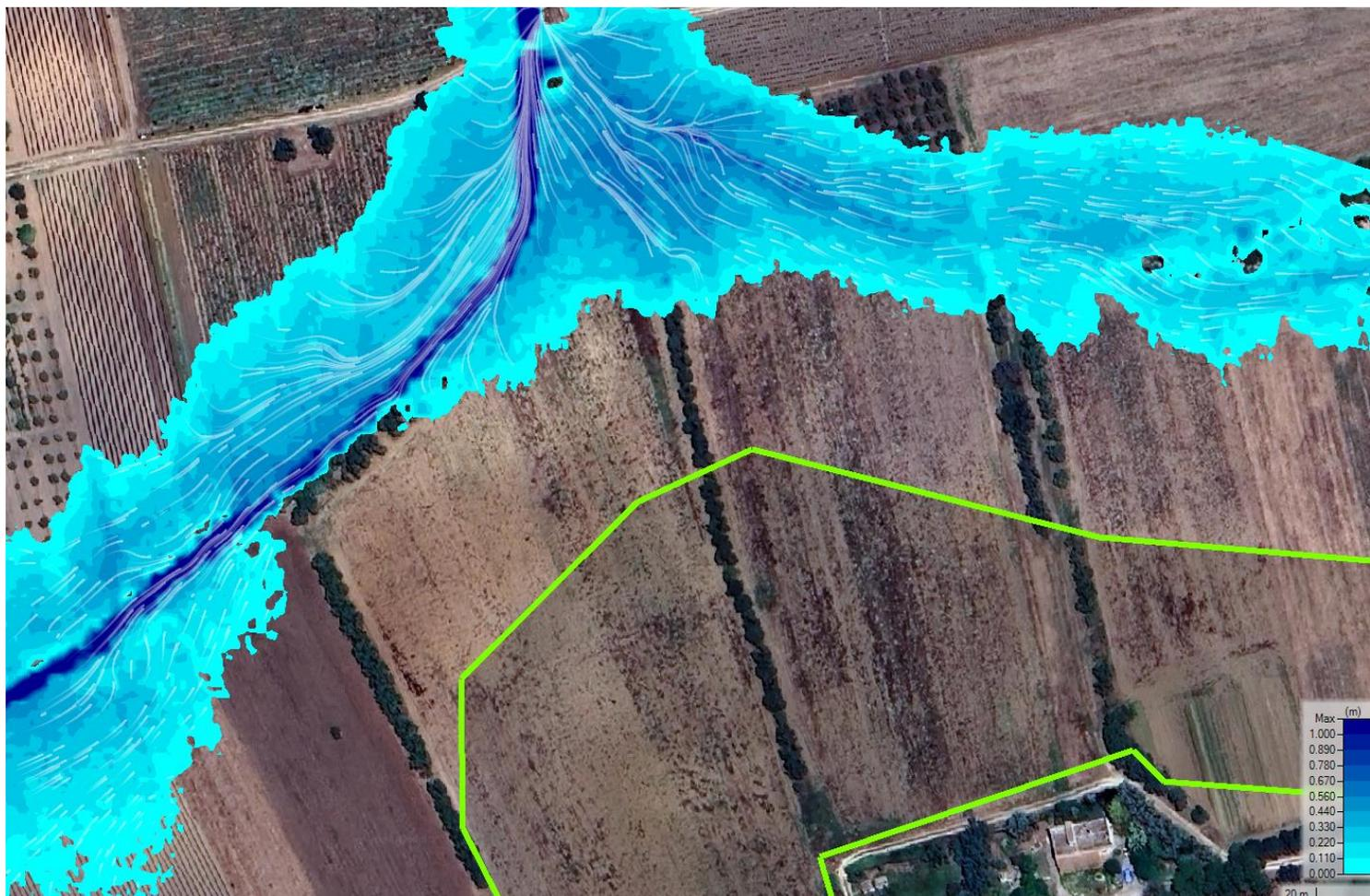
Figura 27 - Mappa aree inondabili Tr200 Anni con altezza del tirante idrico e direzione del flusso delle particelle (zona impianto)
