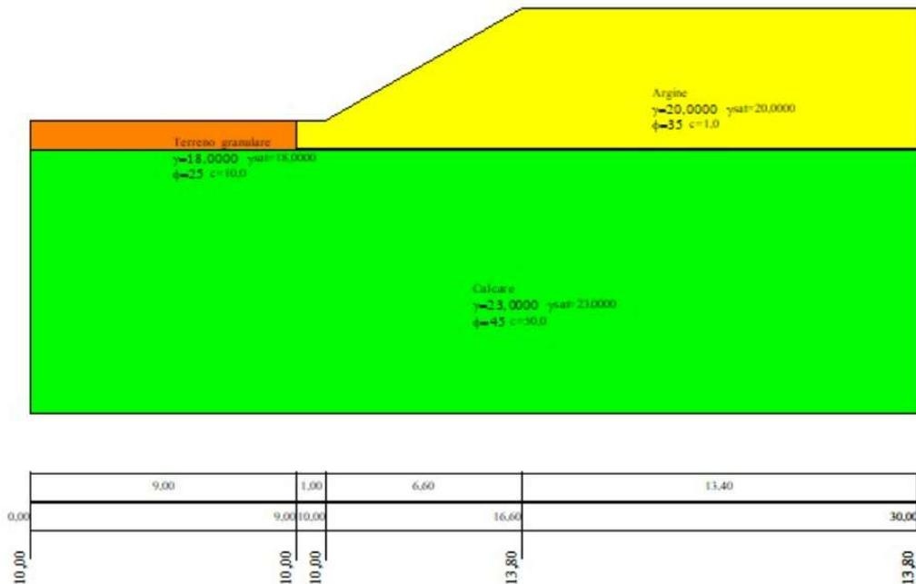
**Figura 5-6 - Sezione di calcolo rilevato arginale**
