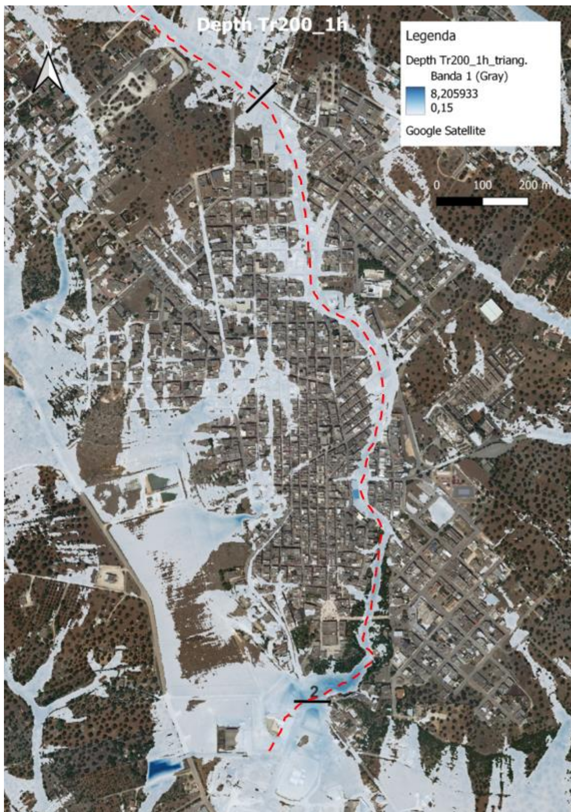
Figura 15 – Battenti stato attuale ottenuti con simulazione di 1 ora TR 200 anni con modello puramente 2D
