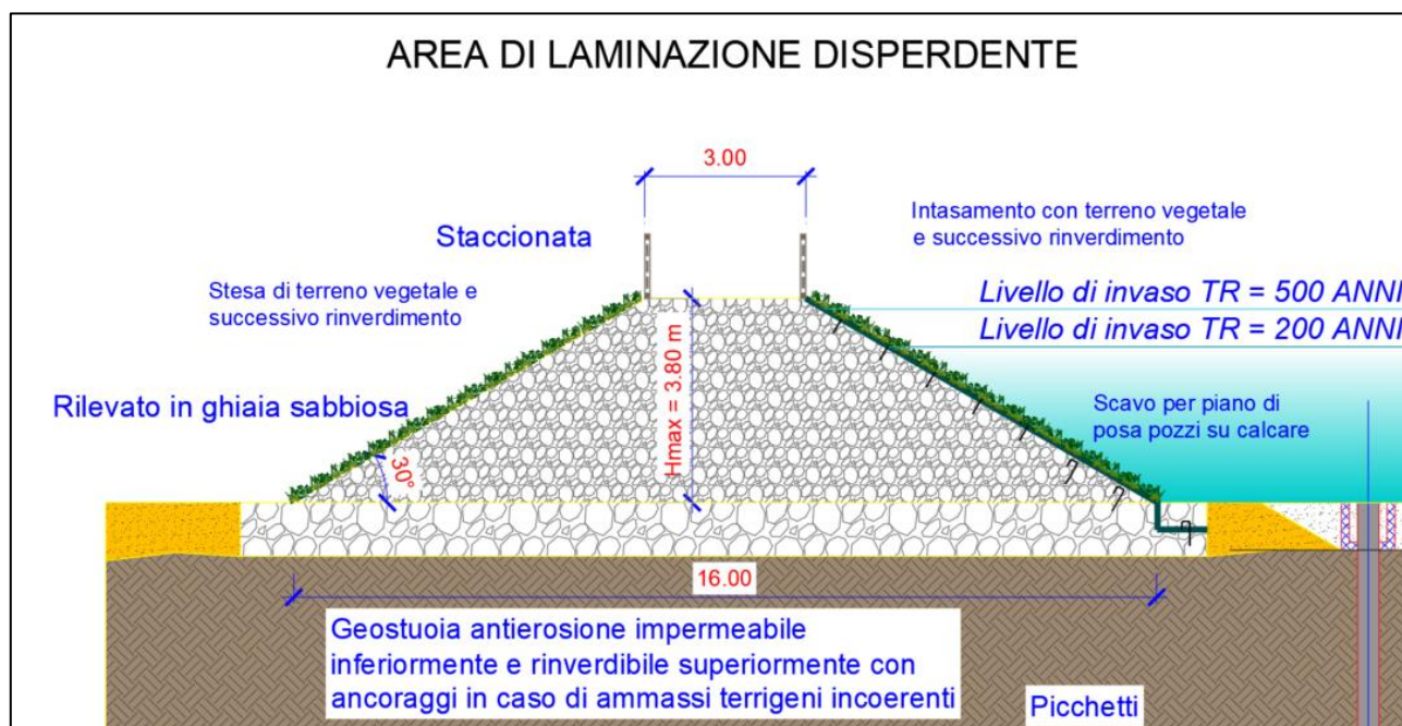
Figura 71 – Nuova sezione trasversale argine adeguata per Tr500
