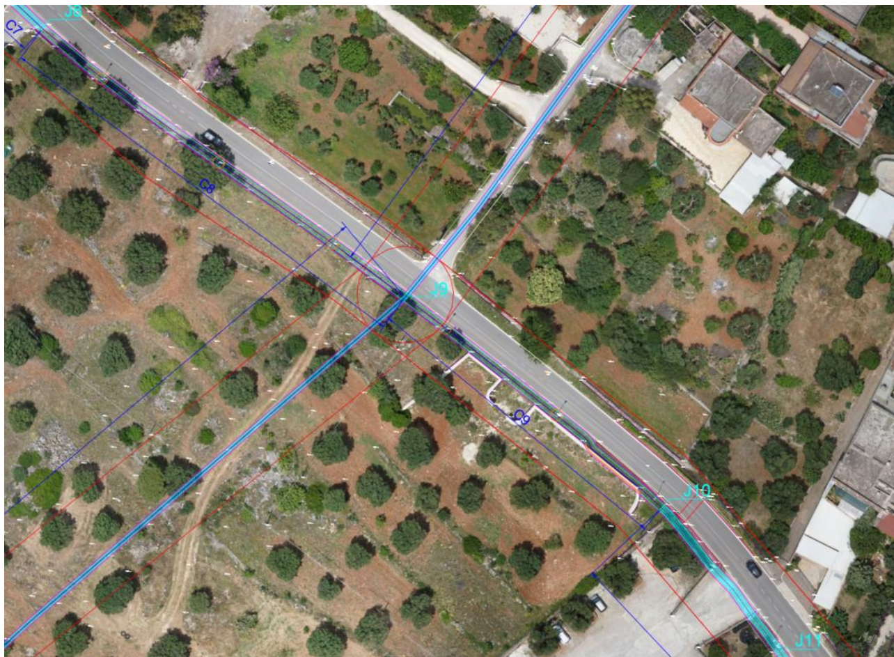
Figura 27 – Particolare planimetria stato di progetto nodi J8-J11
