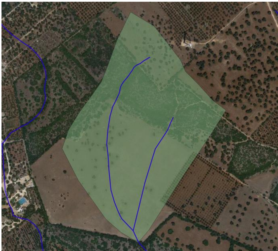
Figura 54 – Bacino idrografico in uscita dall'area di laminazione allo stato attuale, la cui portata non deve essere superata in uscita dalla bocca tarata di progetto
