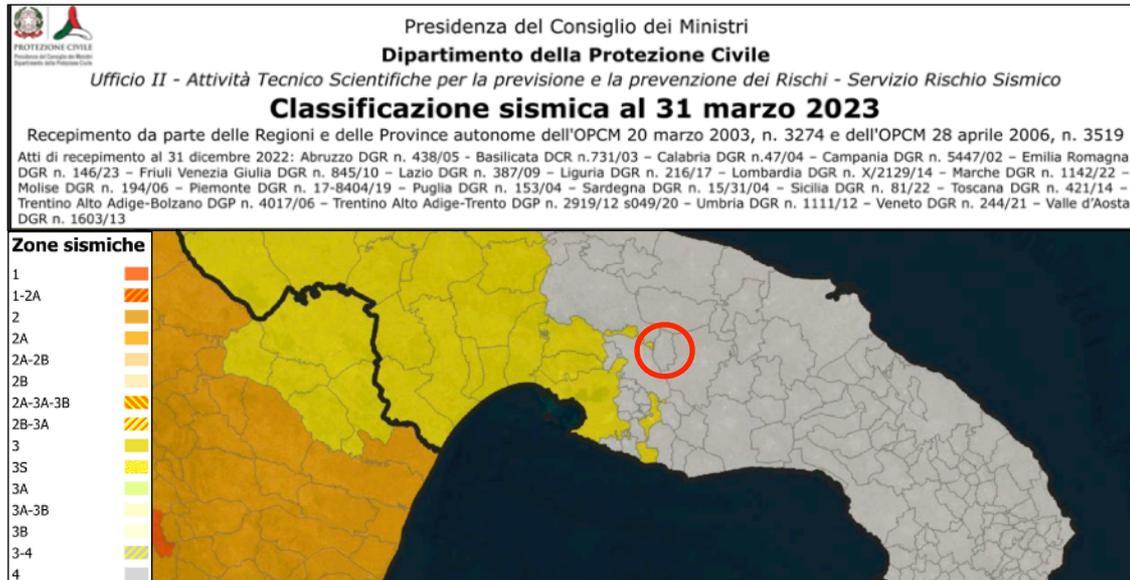
Figura 14: Villa Castelli risulta classificato sismico in Zona n. 4 ai sensi della D.G.R. n°153 del 02/03/2004, emanata in attuazione della OPCM 3274/2003.
