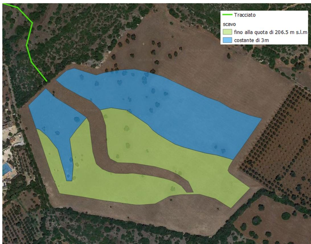
Fig. 5.18 – Planimetria e differenziazione delle aree scavate
