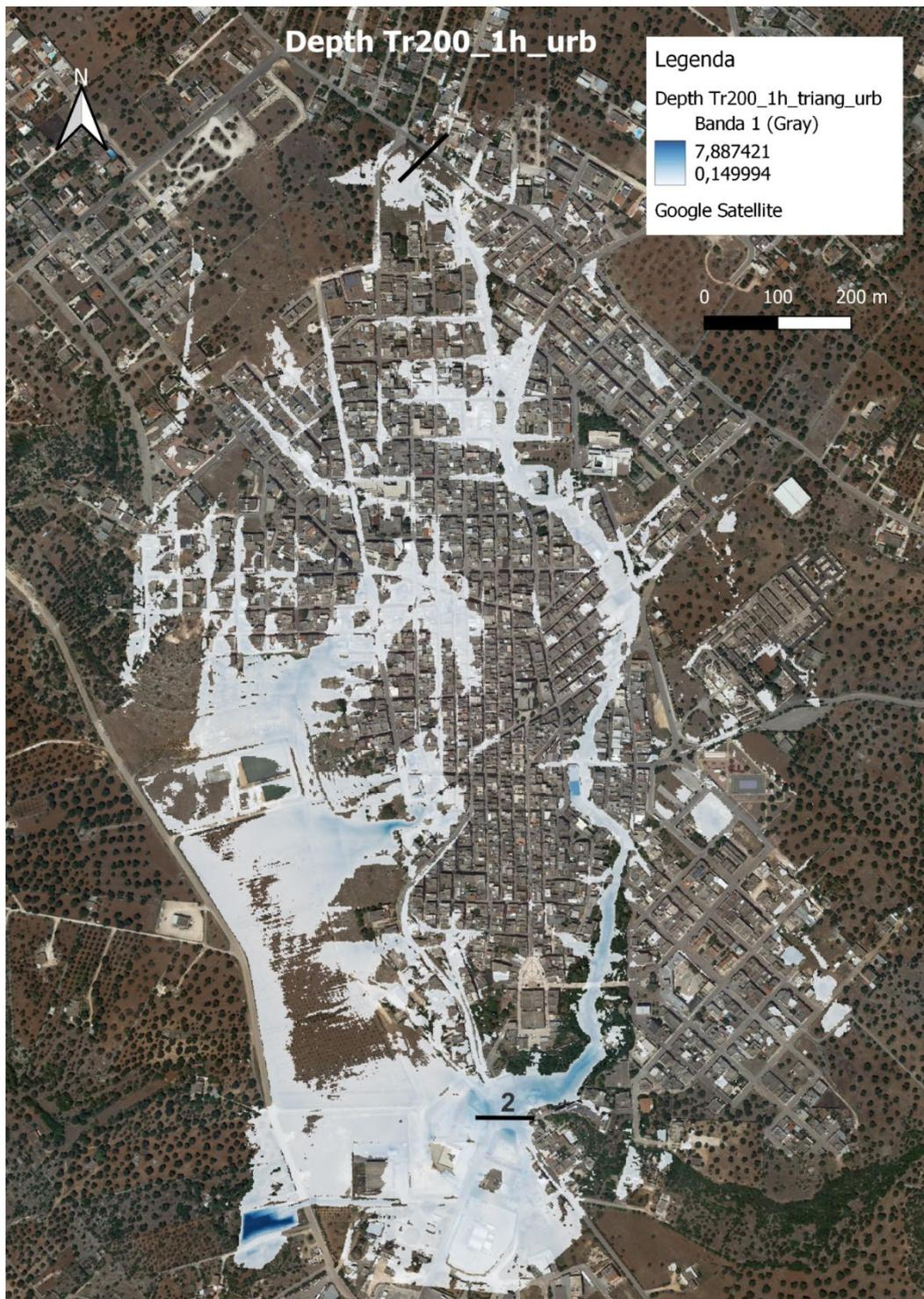
Fig. 5.23 – Battenti ottenuti con simulazione di 1 ora solo deflusso urbano
