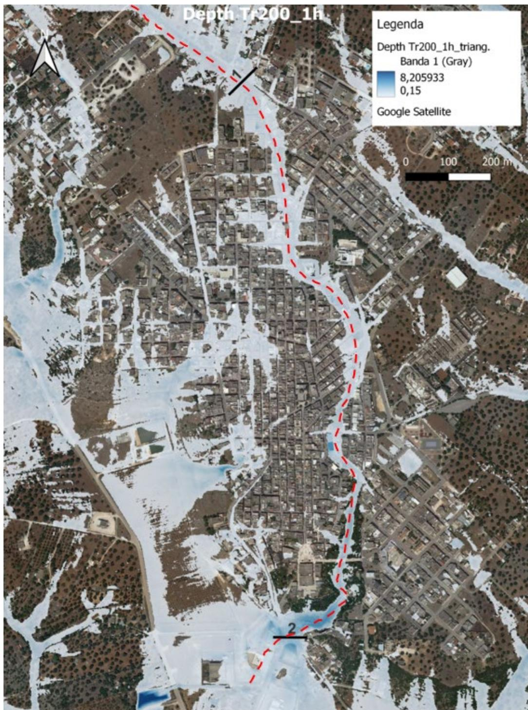
Fig. 2.4 – Battenti stato attuale ottenuti con simulazione di 1 ora TR 200 anni con modello puramente 2D
