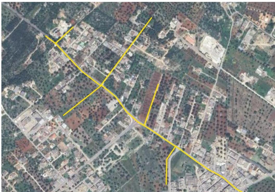
Fig. 3.3 – Sistema di intercettazione mediante bracci trasversali alla dorsale principale
