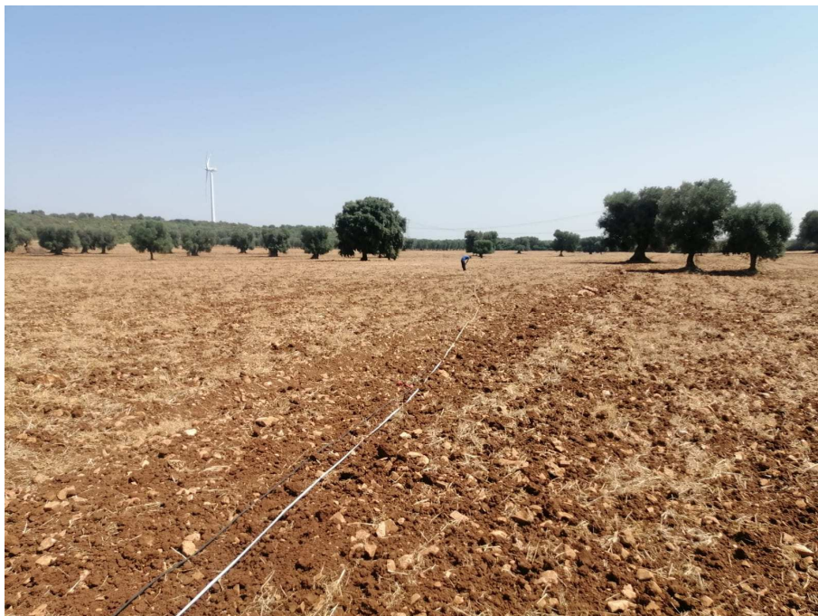
Esecuzione indagine sismica MASW 3
