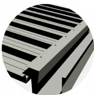
Profilo mascheramento poliuretano+canale di gronda
