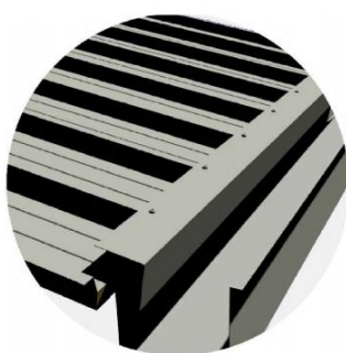
Profilo mascheramento poliuretano+canale di gronda
